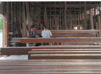
扇建築工房の家づくりでは、丁寧に天然乾燥された地元の「天竜材」を用いる。全棟、大工が手刻みで加工する。山の文化を継ぐことにもつながっている
