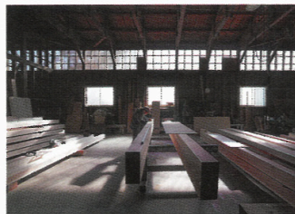
扇建築工房の家づくりでは、丁寧に天然乾燥された地元の「天竜材」を用いる。全棟、大工が手刻みで加工する。山の文化を継ぐことにもつながっている
